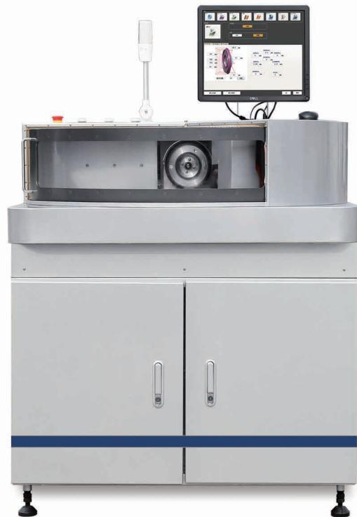
1. 直觀的 3D 圖形界面，使操作非常簡單，無需經驗即可輕鬆操作，可根據客戶的需求，修改參數，研磨出需要的理想刀具。
